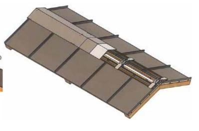
9 • Clipser un nouvel élément de faîtage et glisser le au niveau de la chemise en laissant un jeu pour assurer la dilatation entre les éléments de faîtage.
