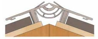
5 • Positionner les pattes OTOP avec un entraxe de 500 mm.
