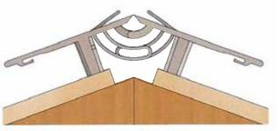
3 • Mise en œuvre des bacs avec relevé de tête de 25 mm.
