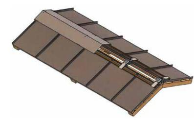
Calepiner les éléments de faîtage. La jonction se fait au milieu des 2 pattes OTOP. 8 • Mise en place de l'éclisse au niveau de la jonction.
